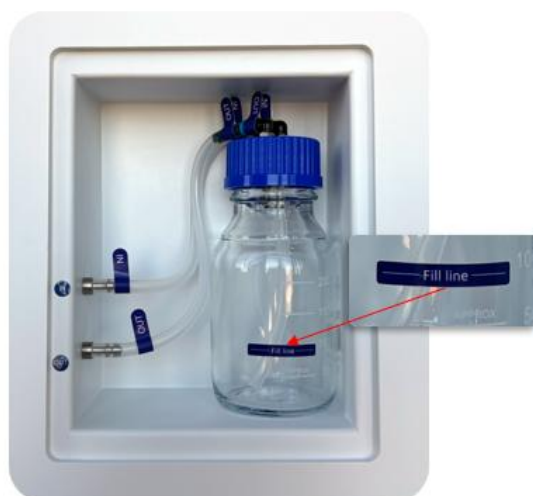
Figur 21.1 Slangetilslutning på befugtningsslasken og Multi-zone ART-arbejdsstationen
