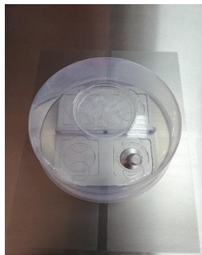
Figur 11.8 Gasudløbet skal placeres over gasdysen
