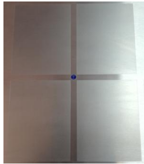
Figur 11.7 Gasmundstykke i bordpladen
